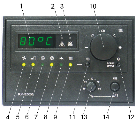
Rysunek 1. Płyta czołowa regulatora RK-2006
