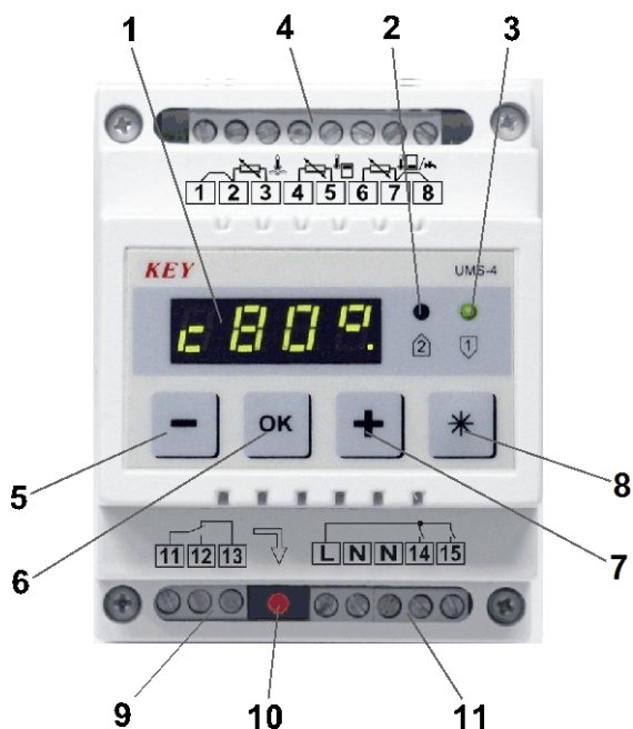
Rysunek 1. Widok płyty czołowej modułu UMS-4A.
